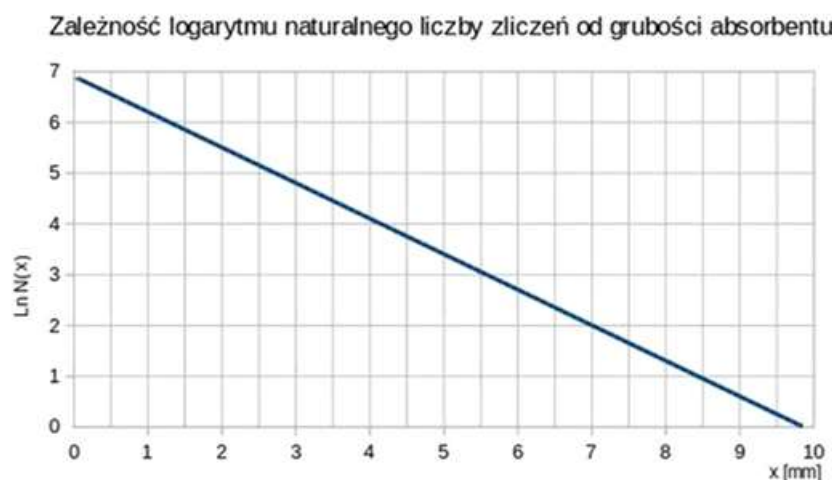
Rys. 4. Prawo osłabienia wiązki promieniowania elektromagnetyczne w skali półlogarytmicznej, wzór (3).
